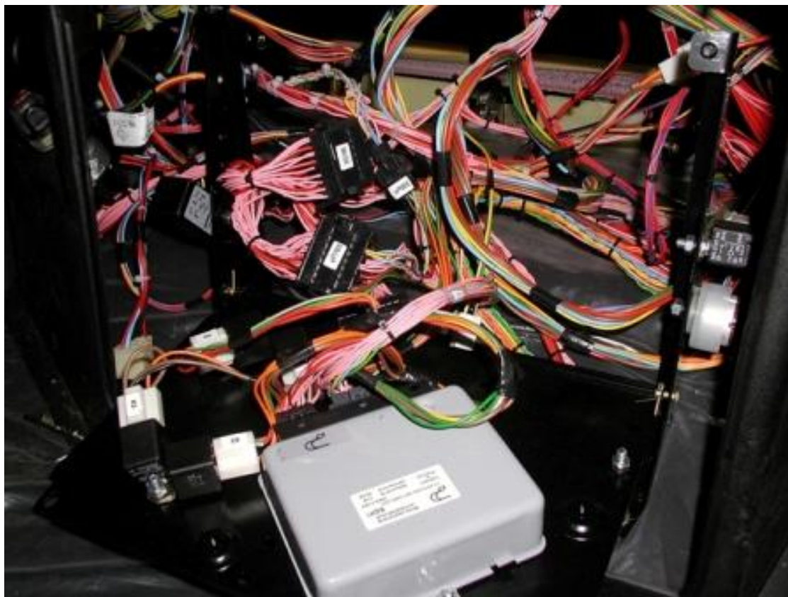
Рисунок 2 – Область подключения к шине CAN.
