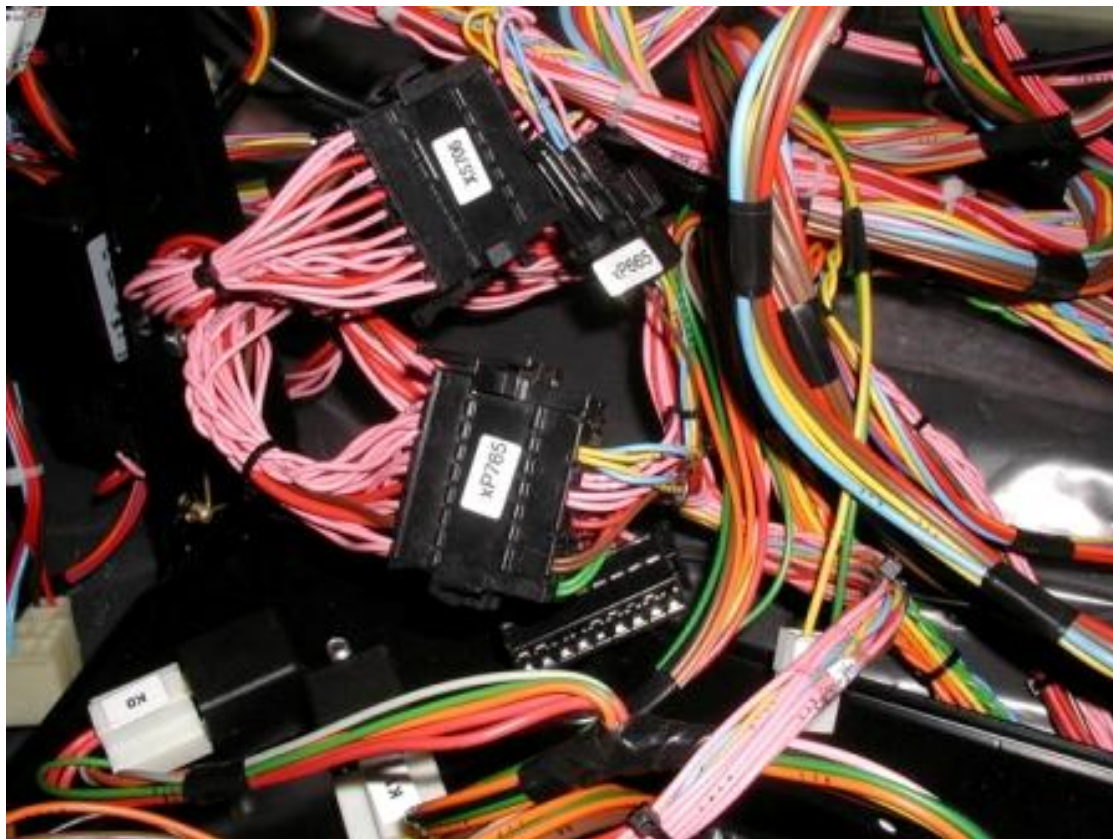
Рисунок 3 – Шина CAN заведённая в колодку XP765.
